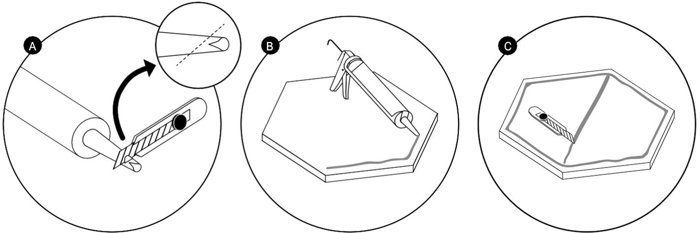
**Achtung!** Vermeiden Sie es, die Oberfläche der Paneele mit dem Klebstoff zu verfärben. Sollten Sie etwas Klebstoff auf die Paneele bekommen, entfernen Sie sie vorsichtig mit der Spitze des Teppichmessers oder eines Schwammes. Schmieren Sie den Kleber nicht! Lassen Sie den Klebstoff nicht trocknen - das Abkratzen kann die Paneele Oberfläche beschädigen. Es wird abgeraten, die Paneele miteinander zu kleben.
